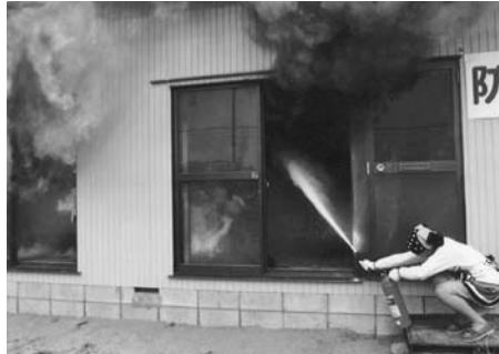
粉末消火器による火勢抑制法実験
